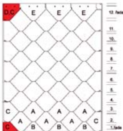
Obr. 3 - Smaragd rozlatování (sudé řady) a zmenšení/zvětšení konstrukční šíře (pokládka zprava) ***
