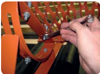
Obr. 6 Připevnění stoupací lávky
