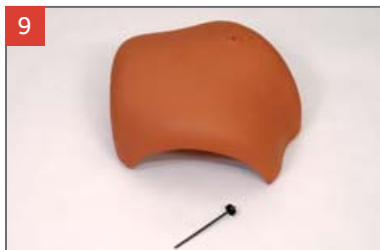
9 Rozdělovací hřebenáč kónický K s jedním vrutem Pro napojení hřebene a 2 nároží. Pro sklony střech 20° až 60°.
