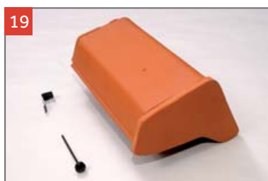
19 Univerzální pultový hřebenáč začáteční, pravý s jednou příchytkou hřebenáče HO + N a s jedním vrutem Pro napojení pultové hrany na štítovou.
