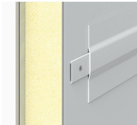
Obr. 6: Stabilizace páskou z fóliového plechu (znázorněno) nebo přitlačnou lištou
