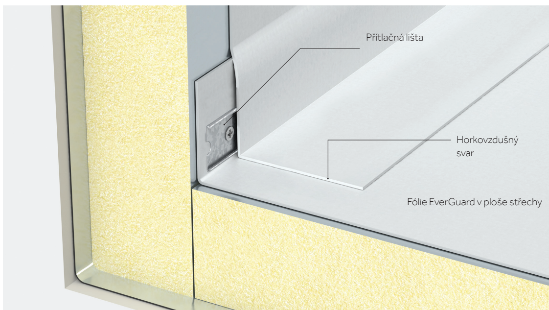
Obr. 2: Ukončení na prostupující konstrukci pomocí přítlačné lišty
