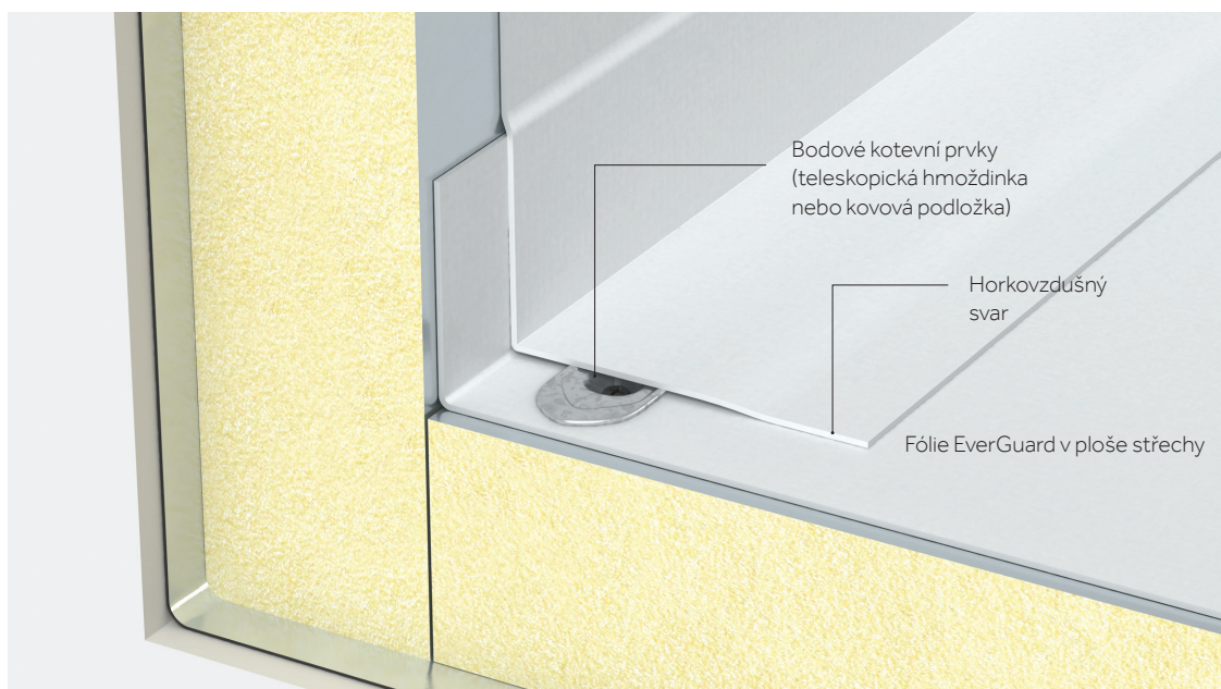
Obr. 3: Příklad - nutno přizpůsobit místním podmínkám
