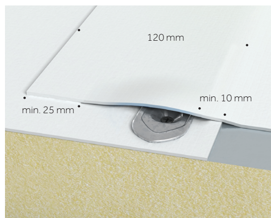
Příklad podélného spoje s ocelovou podložkou
