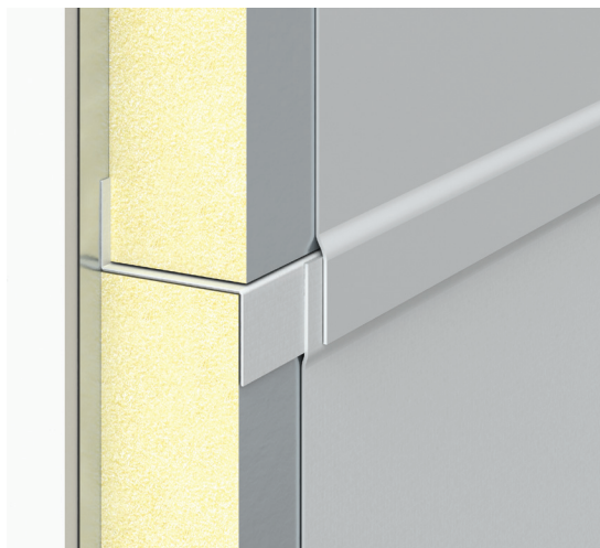
Obr. 8: Stabilizace Z profilem z fóliového plechu
