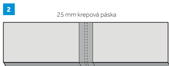
Překrytí dilatační spáry krepovou páskou šířky 25 mm
