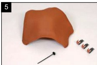
SET rozdělovací hřebenáč drážkový HO s třemi přichytkami hřebenáče HO+N a s jedním vrutem Pro napojení hřebene a dvou nároží. Pro sklony střech 15° až 55°. Přípevnění: 3 přichytky HO+N se 3 vruty 4x66 mm nebo jeden utěšňovací vrut.
