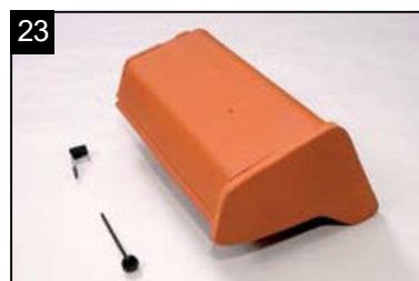
23 SET univerzální pultový hřebenáč začáteční, pravý s jednou přichytkou hřebenáče HO + N a s jedním vrutem Pro napojení pultové hrany na štítovou.
